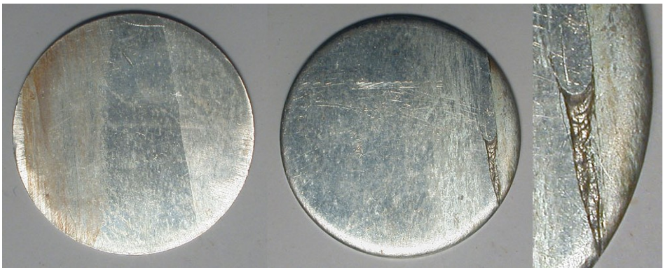
Tin, 10,6 gram, 29,95 mm, gietgal en dubbeling. Zinn, 10,6 Gram, 29,95 mm, Lunker und Dopplung.
